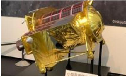
Innerhalb der SLIM-Mission der japanischen Raumfahrtagentur JAXA befindet sich aktuell ein Amateurfunksender auf dem Mond. Kurz vor der Landung der Sonde wurden die Nutzlasten LEV-1 und LEV-2 abgesetzt. Die gesammelten Daten von LEV-2 werden von LEV-1 empfangen und als Bake auf 437,41 MHz mit 1 W gesendet. LEV-1 arbeitet unter dem Rufzeichen JS1YMG [1]. Allerdings kämpft die Mission mit technischen Problemen, wird von JAXA aber dennoch als Erfolg gewertet [2].
